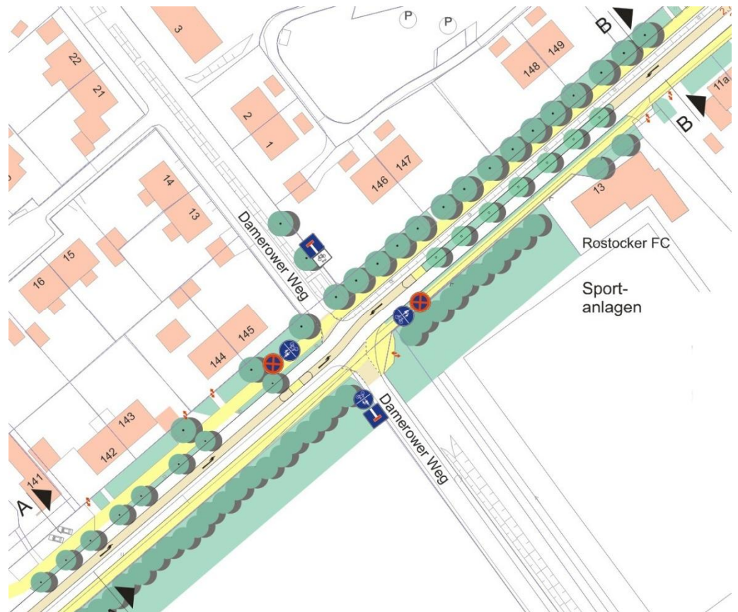
Abb. 21 Gestaltungsvorschlag mit Mittelstreifen (Bereich Damerower Weg)
